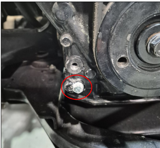
Fig. 1.24 Lower Left Stud Replacement
